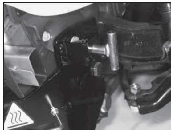
Korrekt montierter Bügel. Mit der gegenüberliegenden Seite ebenso verfahren.
