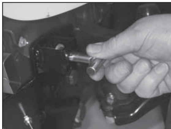
Bügel durch die Bohrung von Anbaurahmen und den Träger des Rasentraktors schieben
